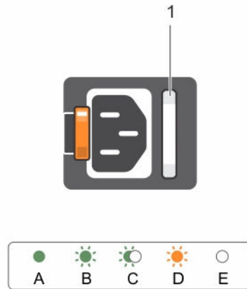
Abbildung 7. Statusanzeige des Wechselstrom-Netzteils
